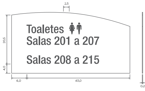
Chapa metálica vistas ortográficas da frente
