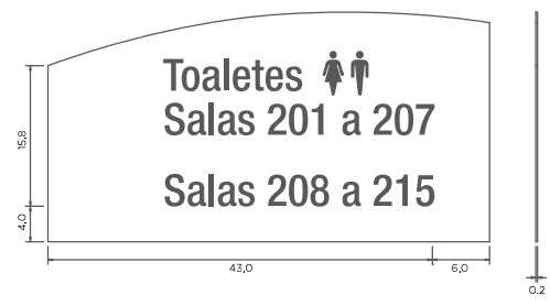
Chapa metálica vistas ortográficas do verso
