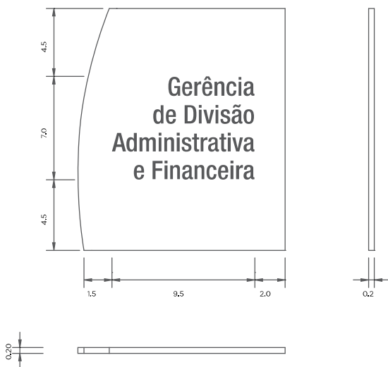
Chapa metálica vistas ortográficas
