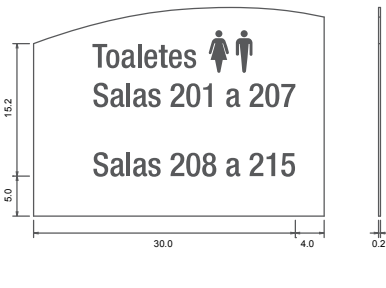
Chapa metálica vistas ortográficas do verso
