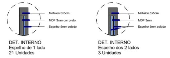
Suporte móvel com rodas em metalon 5x5cm pintado na cor preta, fixado com chapa em MDF na cor preta 3mm com espelho 5mm colado
