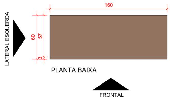
Armários sendo nichos e tamponamentos em MDF 25mm na cor Carvalho Avelã - Duratex ou equivalente, caixas internas e portas de abrir em MDF 18mm Carvalho Avelã - Duratex ou equivalente, com puxador perfil G em alumínio. Fundo dos armários em MDF 6mm na cor Carvalho Avelã - Duratex ou equivalente.
