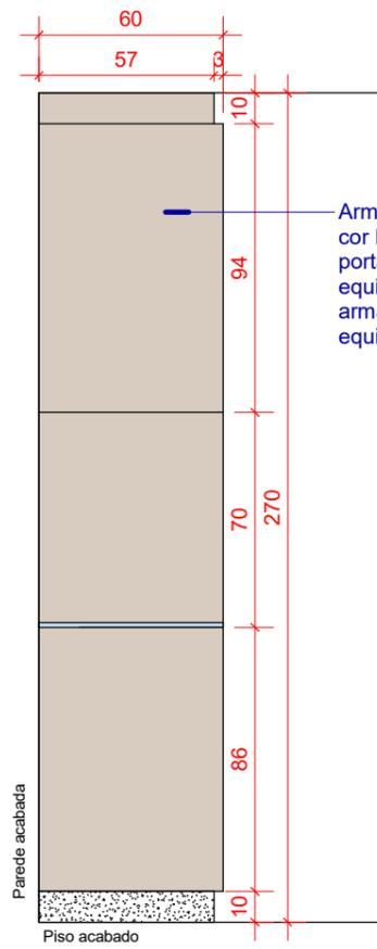
Armário sendo nichos e tamponamento em MDF 25mm na cor Noce Mare - Duratex ou equivalente, caixas internas e portas de abrir em MDF 18mm Noce Mare - Duratex ou equivalente, com puxador perfil G em alumínio. Fundo dos armários em MDF 6mm na cor Noce Mare - Duratex ou equivalente.
